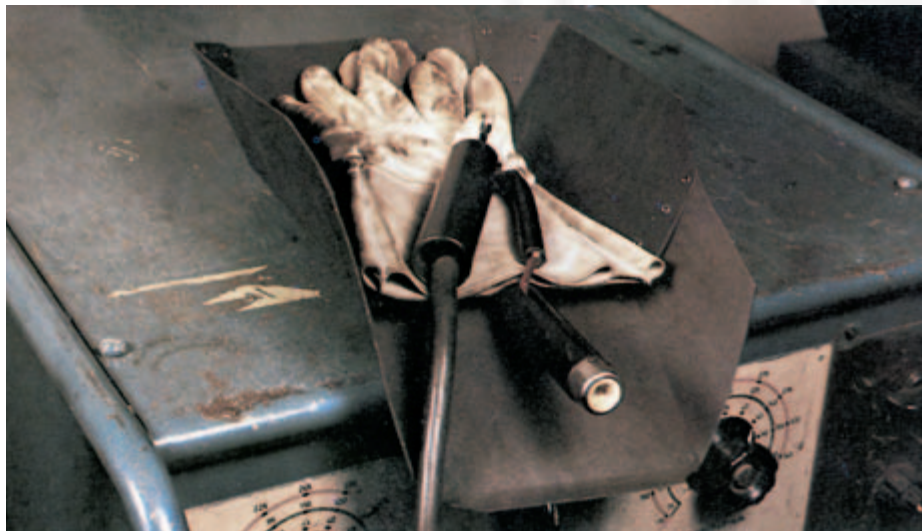
Bild 3-11: Ohne Elektrodenrest isoliert abgelegter Stabelektrodenhalter
