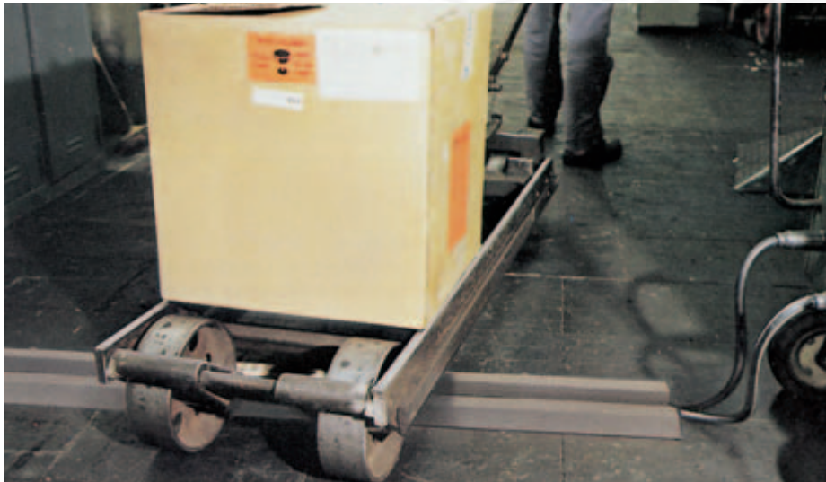
Bild 3-2: Sicherung der Schweißleitungen gegen Beschädigung beim Überfahren
