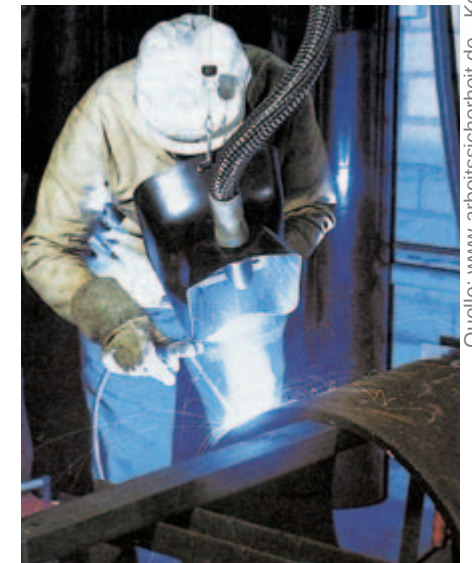
Bild 8-4: Schweißerschutzschild mit integrierter Absaugung
