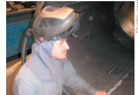
Bild 7-1: Ohr des Lichtbogenschweißers durch die Kopfhäube geschützt
