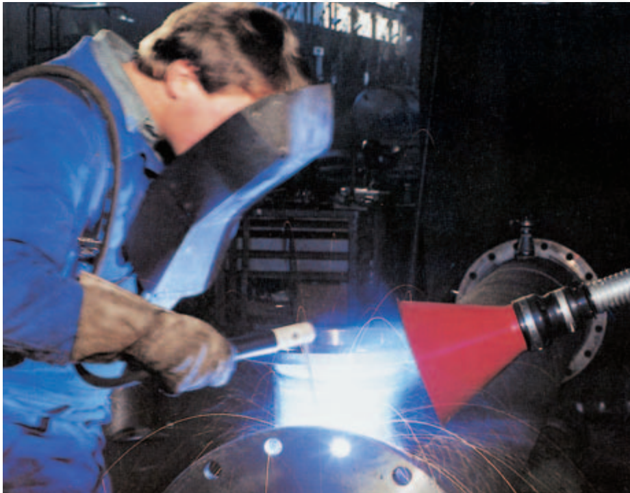
Bild 8-2: Absaugen von Schweißrauch
