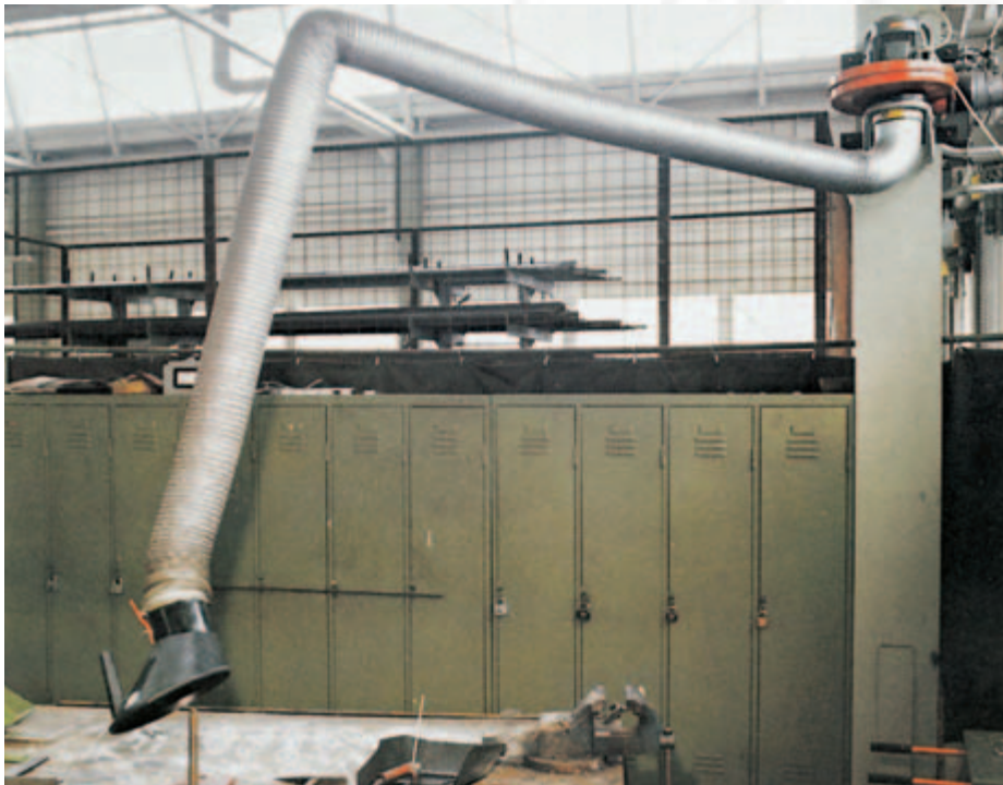
Bild 8-5: Vom Schweißer nachzuführender Absaugrüssel
