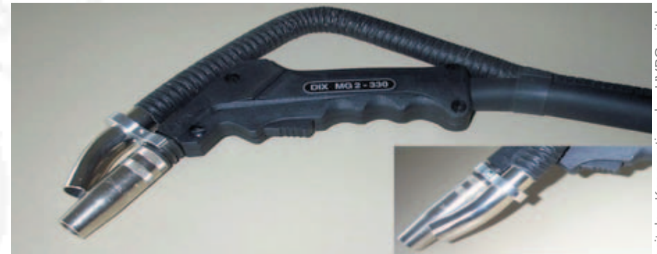
Bild 8-6: Schutzgasbrenner mit integrierter Absaugung mit verstellbarem Erfassungselement
