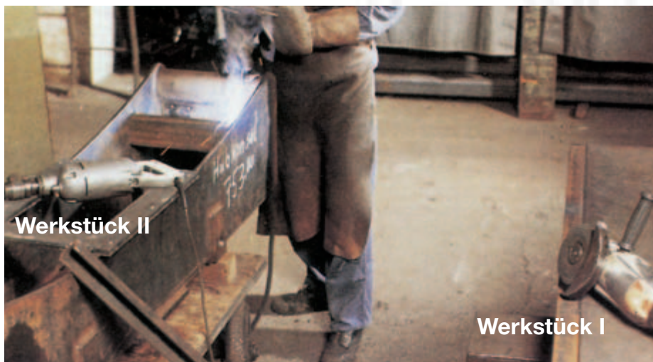
Bild 2-6: Elektrowerkzeuge der Schutzklasse I (mit Schutzleiteranschluss) auf Schweißwerkstücken
