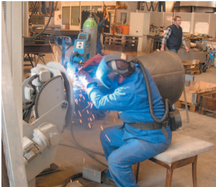
Bild 3-15: Mit oder ohne Auflage – trockenes Holz isoliert den Lichtbogenschweißer
